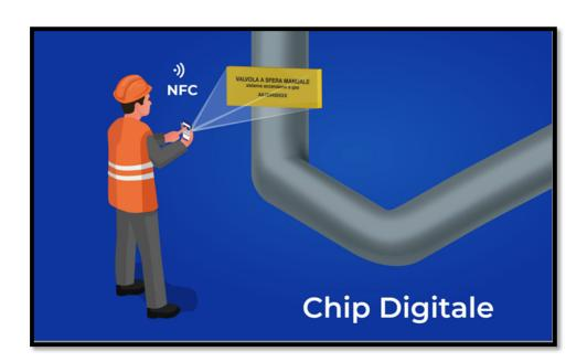
Quando l'etichetta o il dispositivo contenente il chip RFID viene esposto al campo elettromagnetico del lettore, l'antenna del chip cattura il segnale radio elettromagnetico e lo converte in energia elettrica per alimentare il circuito integrato. A questo punto, il chip invia un
